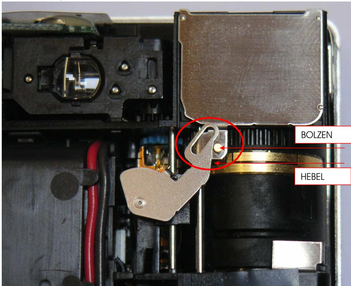
Den Hebel mit Pinzette anheben und den Schutzdeckel so verschieben, dass der Bolzen wieder im Langloch zu Liegen kommt.
