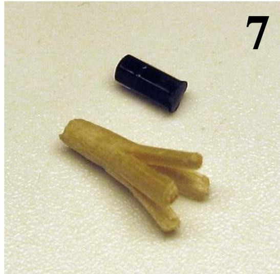
So wird das Teil von unten in das Einstellrad eingesetzt. Nun muss die Blechabdeckung wieder aufgesetzt und festgeschraubt werden. Dabei müssen Sie darauf achten, dass der Holzstift im Loch des Signalgebers landet. Außerdem muss der Einschalter der Kamera unbedingt auf „OFF“ stehen, sonst werden zwei winzige Schalterchen nicht richtig angesteuert oder können gar abbrechen.
