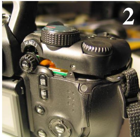
Die Baugruppe wird nun noch an der Kameravorderseite von einer Plastiklasche unterhalb des Auslösers gehalten. Hier muss mit einem Schraubenzieher vorsichtig gehobelt werden, bis sich die Abdeckung anheben lässt. Vorsicht, es entstehen dabei leicht hässliche Scharten an den Plastikkanten. Wenn Ihnen die Gummigrifffläche im Weg ist, können Sie sie leicht herunterklappen oder -schieben.
