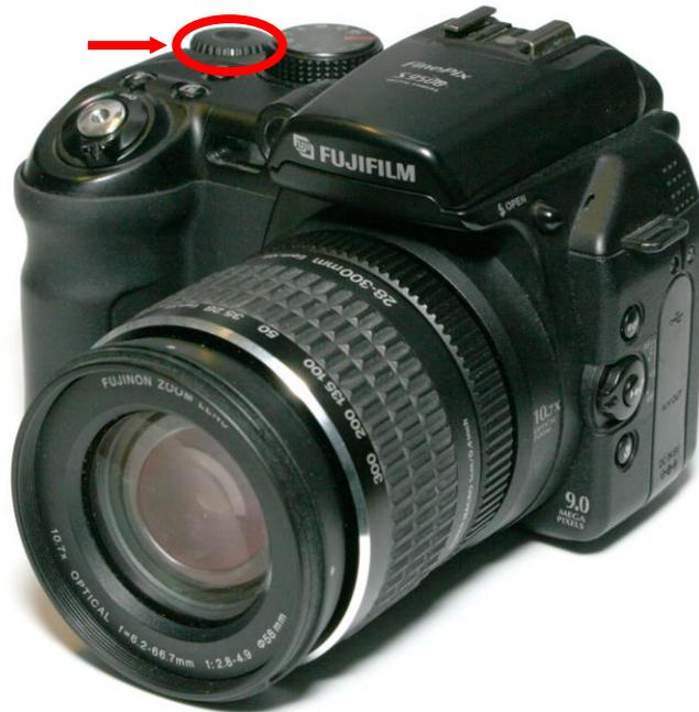
Mit dem im obigen Bild markierten Rad werden bei den Kameras S9500 und S9600 von Fuji zahlreiche Einstellungen vorgenommen, z.B. der Blitzmodus oder die manuelle Einstellung von Belichtungszeit oder Blende. Leider geht dieses Rad aufgrund eines Konstruktionsfehlers fast zwangsläufig irgendwann kaputt. Äußerlich ist der Defekt nicht zu sehen oder zu spüren, es funktioniert nur nicht mehr.
