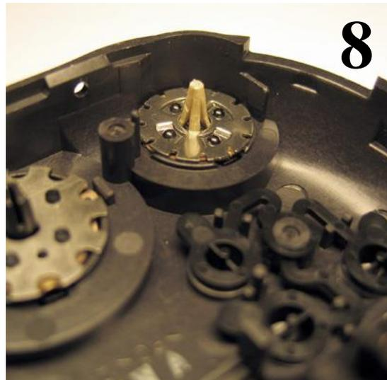
Bevor Sie die Kamera wieder zusammenbauen sollten Sie kontrollieren, ob der Signalgeber sich mitdreht, wenn Sie am Einstellrad drehen. Wenn nicht, ist Ihr Holzersatz möglicherweise zu dünn oder zu kurz. Vielleicht müssen Sie ein wenig experimentieren, bis Ihr Ersatzteil exakt die richtige Form und Größe hat.
